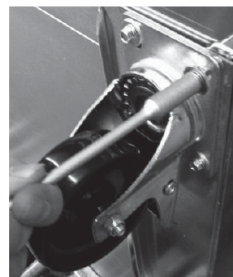
Atornille las ruedas en los mismos agujeros y asegúrese de que se encuentra correctamente nivelado
